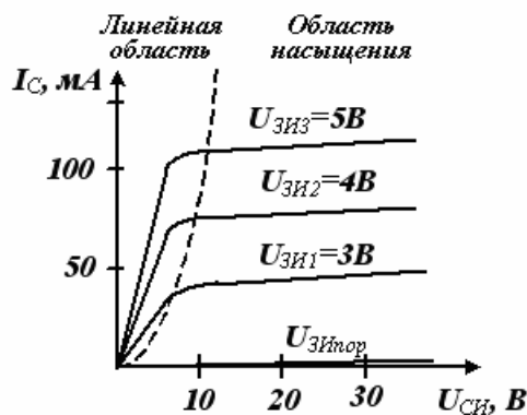
Рисунок 6. Выходные характеристики полевого транзистора КП902
