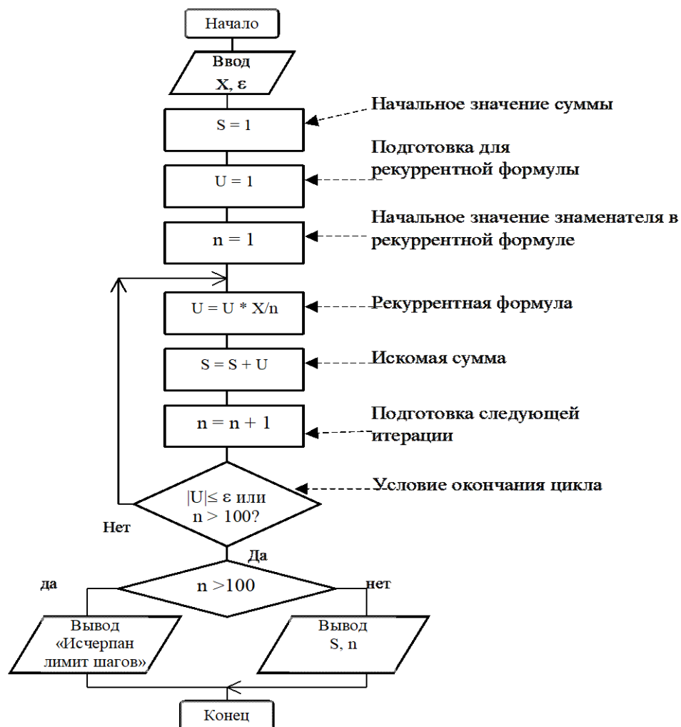
Рисунок 21. Схема алгоритма вычисления экспоненты с заданной точностью
